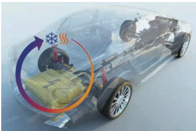
图 40 Gentherm 电池热管理系统
